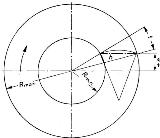
nach oben exzentrisches Kurvenscheibengetriebe
