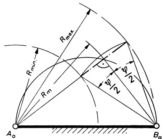
Konstruktion eines zentrischen Kurvenscheibengetriebes
