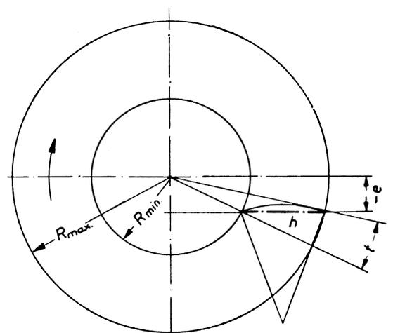
nach unten exzentrisches Kurvenscheibengetriebe
