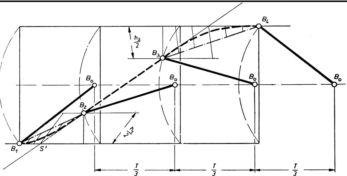
Innerhalb der Abtriebsbewegung sind zwei Lagen der Rolle  $B_2$  und  $B_3$  vorgeschrieben. Die Verbindungsgerade ist gemeinsame mittlere Tangente.
