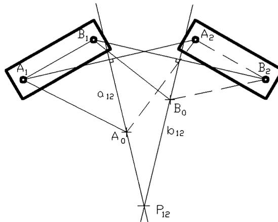
c. Viereckengetriebe ausgehend von  $A_0$  und  $B_0$
