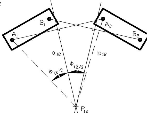
b. Viereckengetriebe ausgehend von A und B
