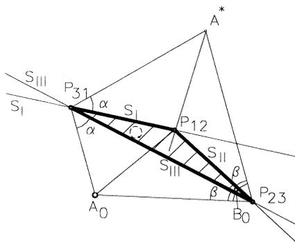
d. Konstruktion der homologen Punkte
